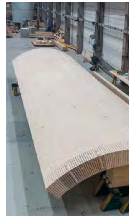
Das Schichtholz wird in Segmenten verpresst und erhält aussen einen wasserfesten Anstrich.
