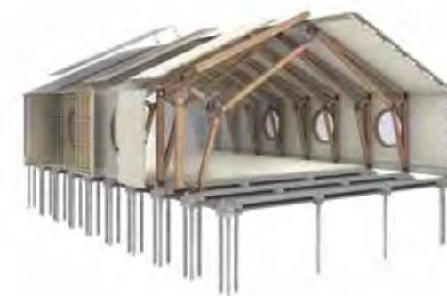
Tragwerk aus Baubuche, ausgesteift mit Wand- und Deckenmodulen aus Fichten-Brettspertholz.
