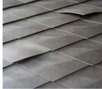
Die Wandplatten aus recykliertem Kaffeesatz, Jeansfasern und Papierbechern können steif verformt werden.
