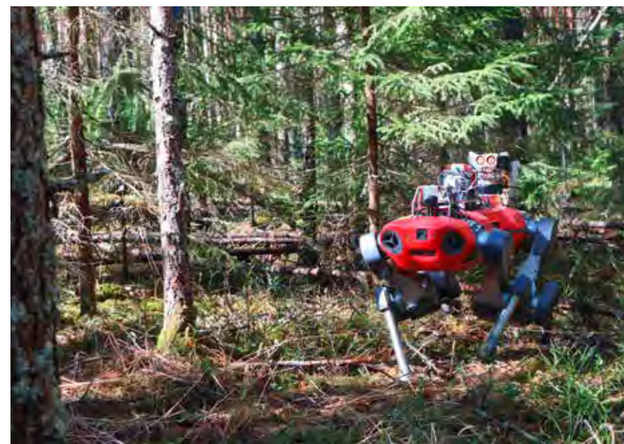
ANYmal unterwegs bei der Datenaufnahme. Der Roboter erfasst beim Vorbeigehen automatisch Daten wie zum Beispiel Durchmesser, Position, Höhe und Volumen.
