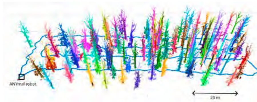
Die Route des Roboterhundes, auf der dieser autonom den Wald erkundet und Bäume segmentiert.
