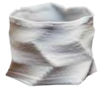
Die gedruckten Objekte lassen sich ohne Formverlust mehrfach rehydrieren.
