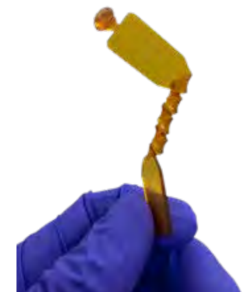
Das Polyamid ist zäh und flexibel und lässt sich dennoch verdrehen, ohne zu brechen.
