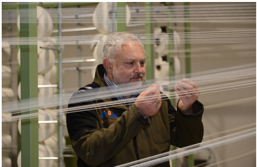
Geschäftsführer Thomas Wildberger kontrolliert die Fäden der neu installierten Textilmaschine, welche die nachhaltigen Netze aus Buchenholz-Zellulose produziert.
