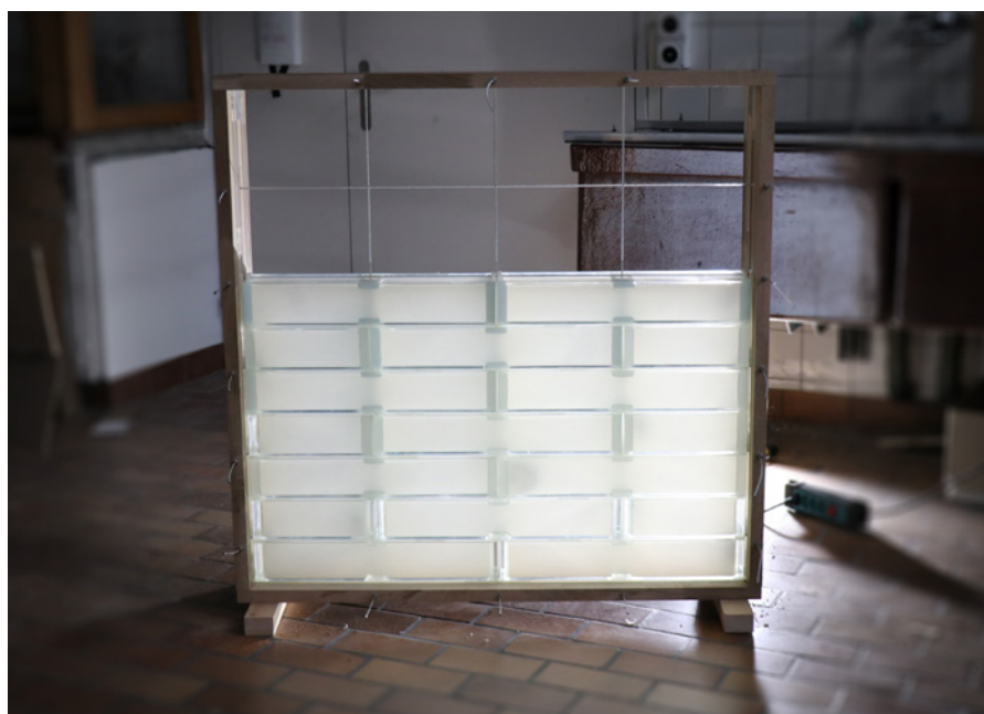
Eine Wand aus Aerogel-Glasbausteinen bringt Tageslicht in den Innenraum – und ist hoch isolierend.
