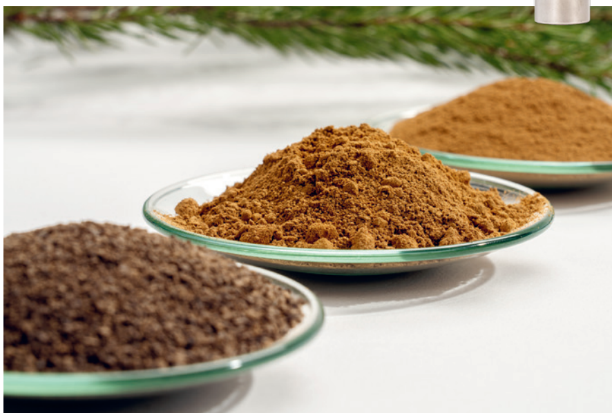
Die Anode der Batterie lässt sich durch ein Lignin-basiertes Material ersetzen.
