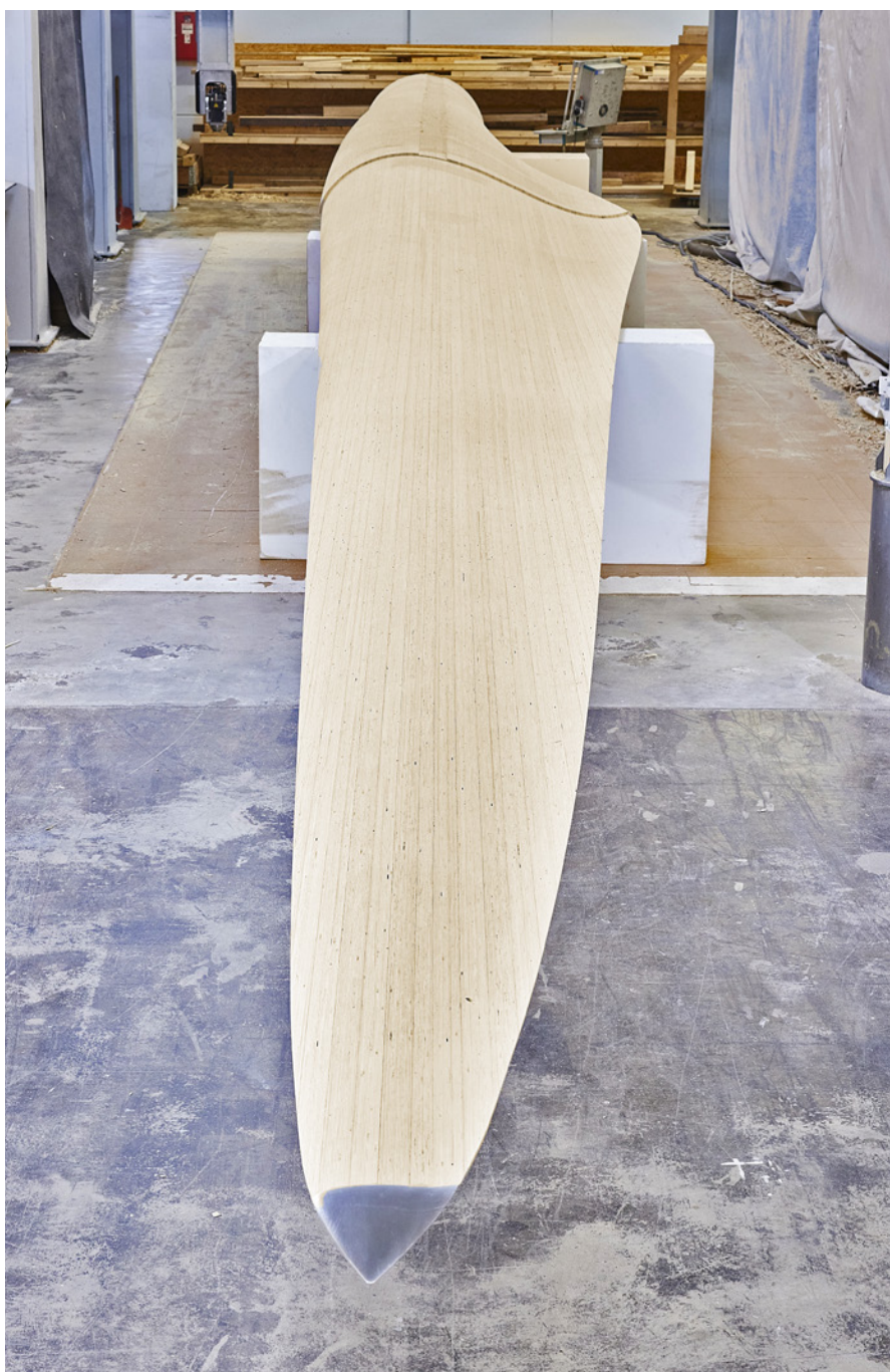
Der Prototyp eines fast 20 Meter langen Rotorblatts aus Furnierschichtholz in der Fertigungshalle.
