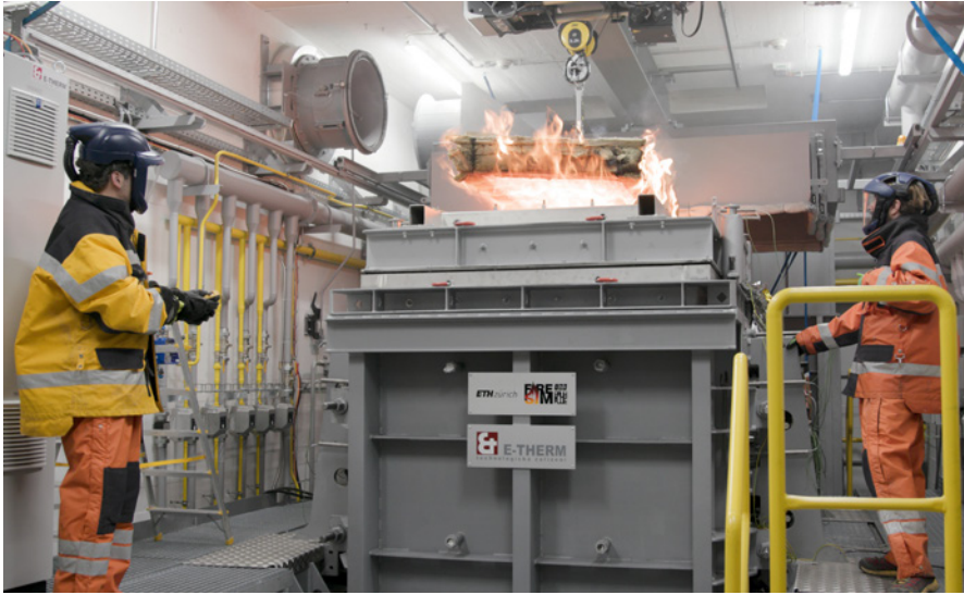
In der Brandkammer der ETHZ Höggerberg können verschiedene Feuer simuliert und die brennenden Holzkonstruktionen gemessen werden.
